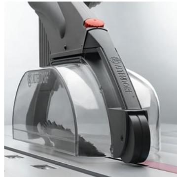
■ **Вытяжной кожух 2 x 46°:** с помощью нескольких движений узкий вытяжной кожух превращается в большой защитный кожух. Для специальных рабочих операций кожух, установленный с передней стороны станка, можно одним движением освободить из зафиксированного положения и отвести в сторону.
