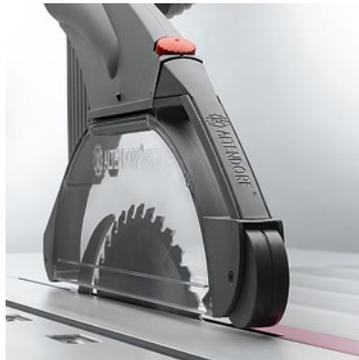
■ **Вытяжной кожух:** для безопасности эксплуатации на станке F45 ELMO III D, как и на остальных форматных круглопильных станках компании Altendorf, применяются только два защитных кожуха. Защитные кожухи обладают конструкцией, оптимизированной с точки зрения параметров потока, а их высота с легкостью регулируется благодаря исполнению в форме параллелограмма.
