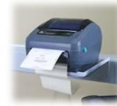
**Принтер.** Принтер штрих-кода Zebra GK420d для печатания этикеток в автономном режиме, вкл. подставку Надёжный термопринтер, 203 dpi, макс. ширина этикетки 108мм. Подключение:USB, Centronics (параллельный)
