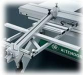
**Поворотный поперечный упор DIGIT L.** Позволяет производить настройку размера по длине с точностью до 0,1 мм. На новом дисплее указаны размеры всех трёх откидных ограничителей. Оператор может вывести на крупный дисплей все размеры, настроенные на откидных ограничителях.
