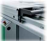
**Двухроликовая каретка.** Легкость хода системы достигается за счет роликов большого размера. Каретка приводится в движение с минимальным усилием и перемещается легко как по рельсам. Такое качество хода сохраняется даже после многолетнего использования станка в обычных условиях.
