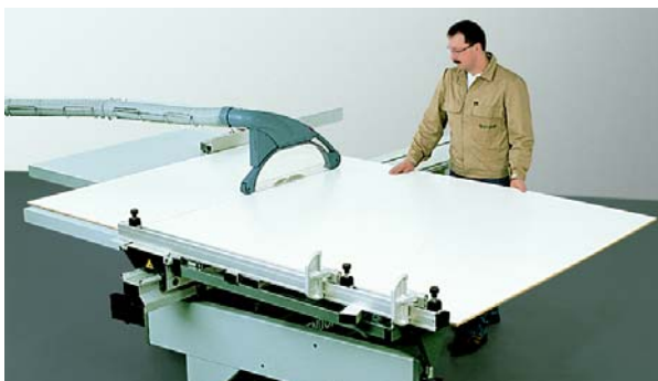
Рис. 6-21: Распиловка крупноформатных плит
