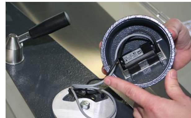
Рис. 6-138: Снимите корпус с устройством электронной индикации
