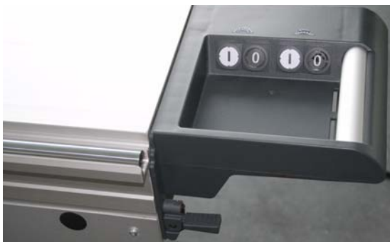
Рис. 6-29: Двухроликовая каретка заблокирована
