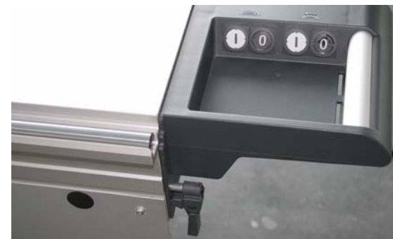
Рис. 6-30: Двухроликовая каретка деблокирована
