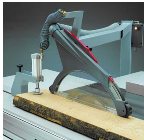
Рис. 6-146: Электропневматическое быстрозажимное приспособление
