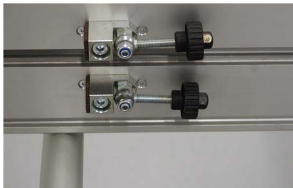
Рис. 5-22: Монтаж одностороннего углового упора с ЧПУ, шаг 3
