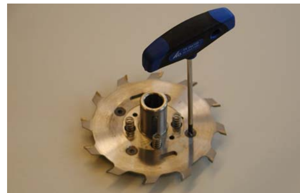
Рис. 6-117: RAPIDO-Plus, монтаж пильного диска
