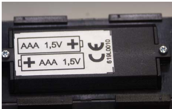
Рис. 6-139: Выкрутите винты и снимите крышку
