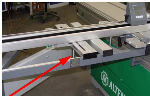
Рис. 5-16: Монтаж углового упора для косых резов WGA_LD
